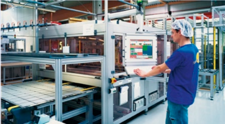
Solarwatt AG: Modulproduktion Layup Foto: Solarwatt AG
