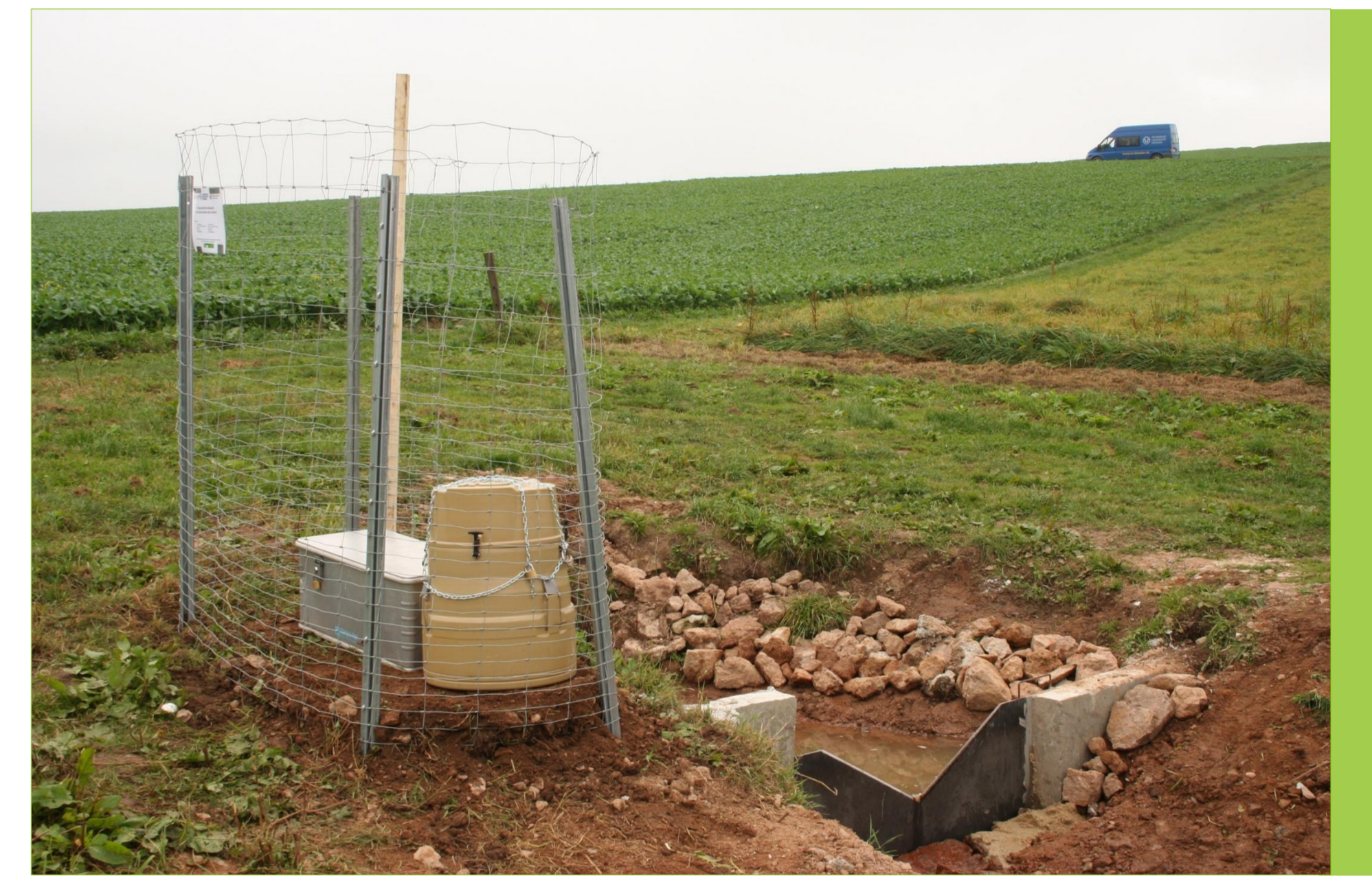
Abbildung 2: Messwehr und Probenahmetechnik im Acker-Probegebiet (Einzugsgebietsfläche 5 ha, Höhe 690 m ü. NN)
